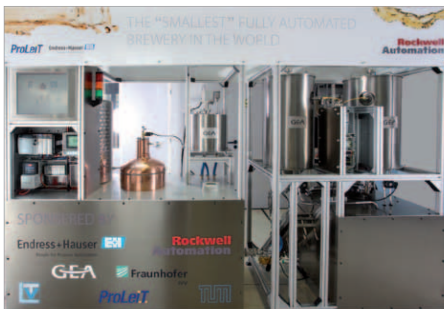
Die „kleinste“ vollautomatisierte Brauerei mit Zwei-Geräte-Sudwerk und einem Gärkeller
